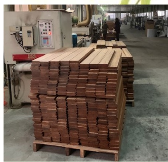
⑦原板を裁断し成形後、必要に応じた仕上加工を施す
