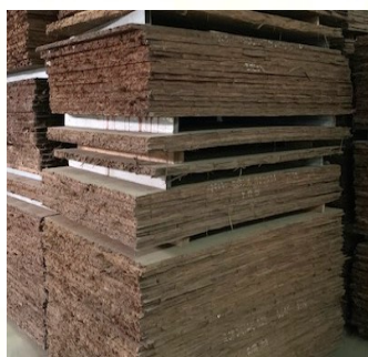
⑥乾燥後、加圧+加熱を同時に行い板状に固める
