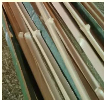
②竹を30~50mmの太さに切り、節を削り取る
