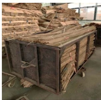
⑤一回目の乾燥後、接着液槽にドブ漬→二回目の乾燥
